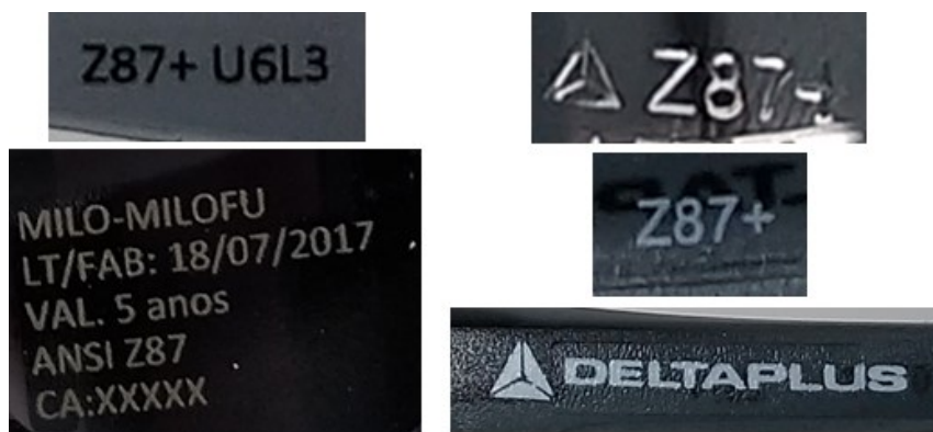
Figura 4 – Marcações presentes nas lentes e hastes dos óculos de segurança com lente fumê
