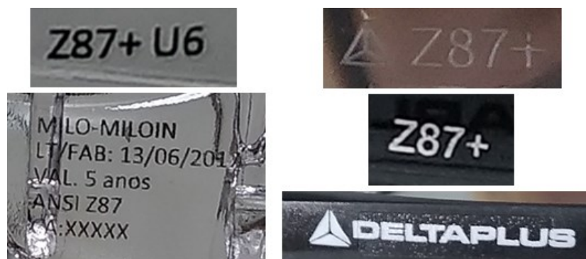
Figura 2 – Marcações presentes nas lentes e hastes dos óculos de segurança com lente incolor
